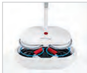
Zum Auswaschen der Pads einfach den Wischmopp in die automatische Waschstation stellen – 4 rotierende Walzen rubbeln den Schmutz aus dem Flor und wringen die Pads anschließend aus.
