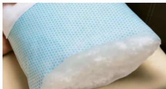
Unmerklich eingearbeitete PCM-Mikrokapseln im Cool-Vlies nehmen überschüssige Körperwärme auf und transportieren sie vom Körper weg.
